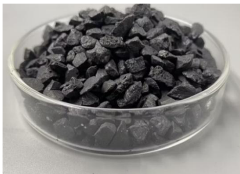
Рисунок 2 — Железный катализатор, используемый в реакции Габера–Боша Figure 2 – Iron catalyst used in the Haber–Bosch reaction
