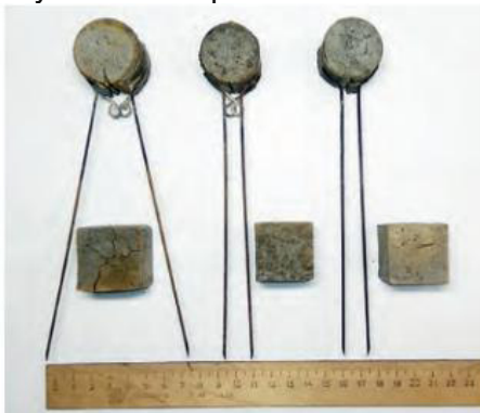
Рисунок 5 – Визуальные характеристики образцов (номера 11, 13, 14 соответственно) после 7 суток твердения (условия: 20 °С, влажность 95 %)
